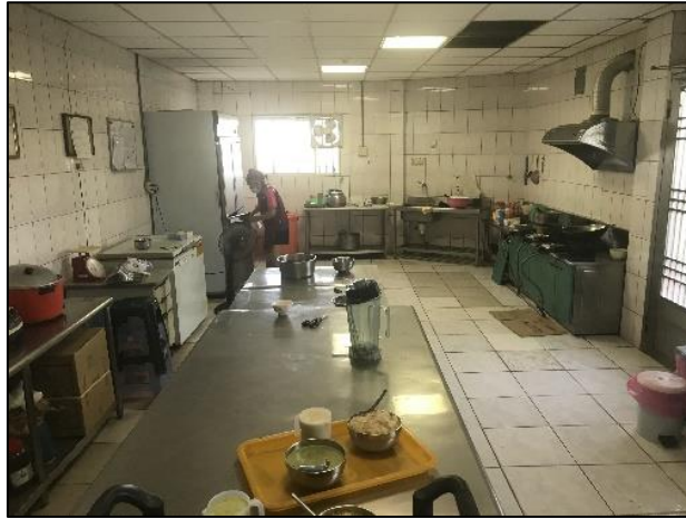
圖 3-49 廚房料理時油煙可能誤觸偵煙型探測器，導致誤報情形發生
